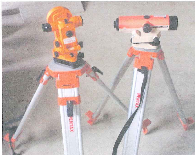
MÁY THỦY BÌNH
